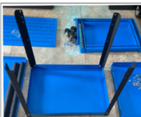
B2: Lắp thanh cố định vào 4 góc mâm đỡ bằng ốc dùi 8mm
