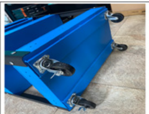
B7 : Lắp bánh xe bằng bulong 8mm
