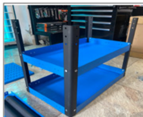
B3 : Lắp tầng 2
